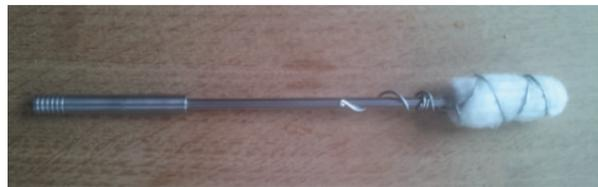
Die weitere Montage entspricht den Bildern 4 - 11, allerdings wird der Draht Draht (Ø 1<sup>+0.01</sup><sub>-0.02</sub> mm) zunächst durch die Bohrung gesteckt und so auf Lebzeit gegen Verdrehen gesichert.
